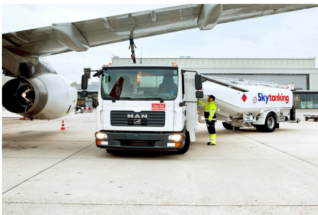
Betankung eines Flugzeugs am Flughafen Stuttgart mit einem Tanklastwagen.
