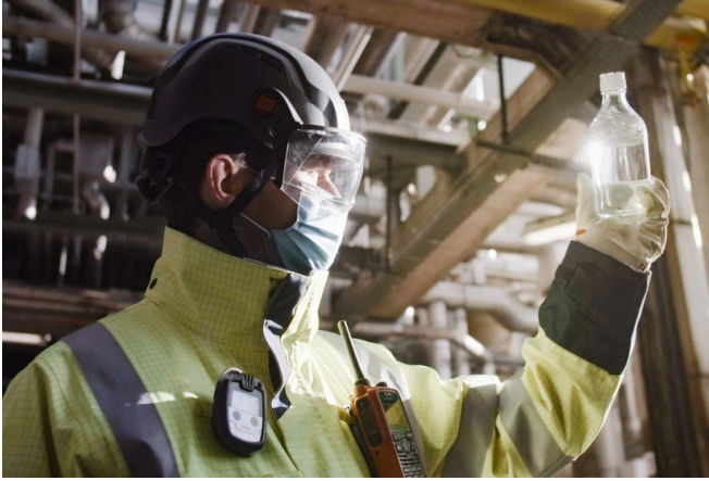
Ein Mitarbeiter von BP in Lingen entnimmt eine Produktprobe des fertigen Biokerosin-Gemischs.
